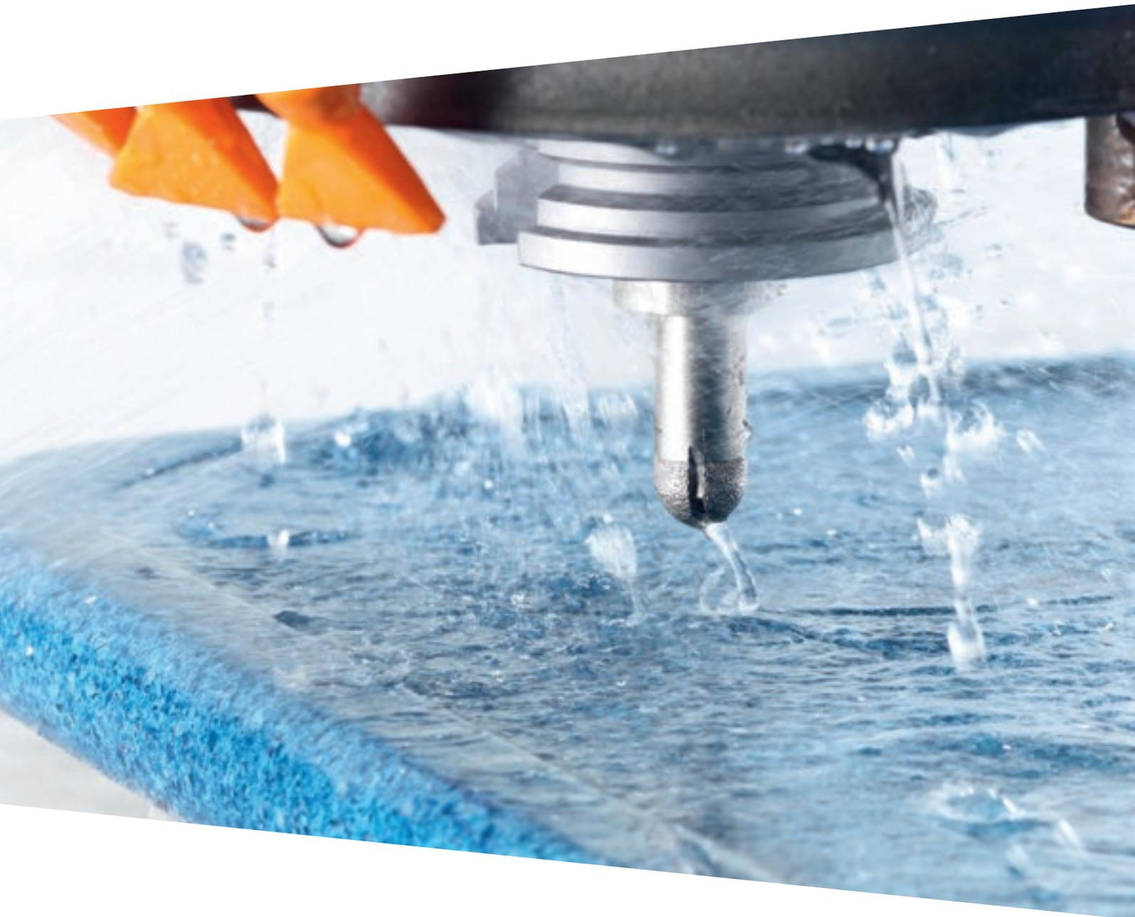
A gama de ferramentas para gotejamentos Diamut inclui fresas de perfilar e rebolos para incisão para máquinas equipadas com agregado específico para incisão.
