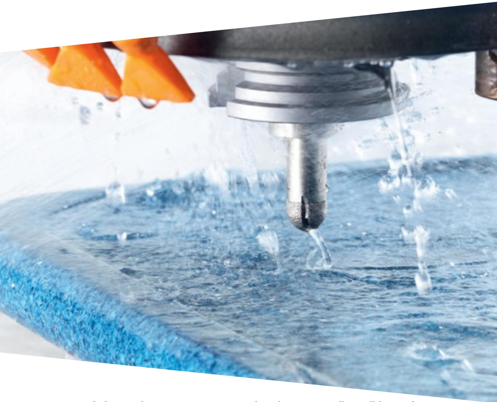
La gama de herramientas para acanalar Diamut incluye fresas de perfilar y muelas de grabado para máquinas dotadas del correspondiente conjunto de grabado.
