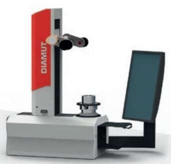
Il nuovo Presetter Diamut è un'apparecchiatura che esegue la lettura del profilo dell' utensile attraverso un software interamente realizzato da Diamut e trasferisce con estrema semplicità all'hardware esterno tutte le informazioni parametriche necessarie per utilizzare l'utensile in macchina e renderlo pronto a plasmare i vari materiali.
