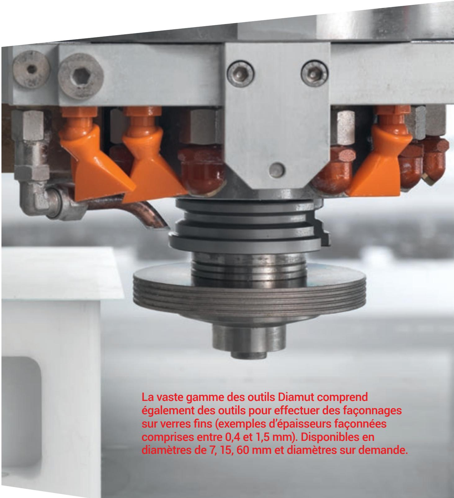
La vaste gamme des outils Diamut comprend également des outils pour effectuer des façonnages sur verres fins (exemples d'épaisseurs façonnées comprises entre 0,4 et 1,5 mm). Disponibles en diamètres de 7, 15, 60 mm et diamètres sur demande.
