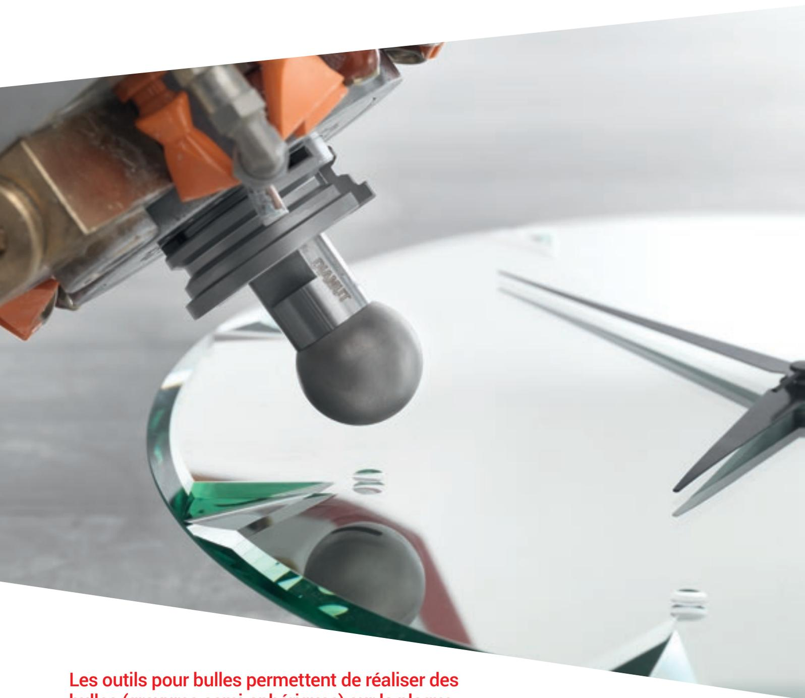
**Les outils pour bulles permettent de réaliser des bulles (gravures semi-sphériques) sur la plaque de verre. Disponibles sur demande en différents diamètres.**
