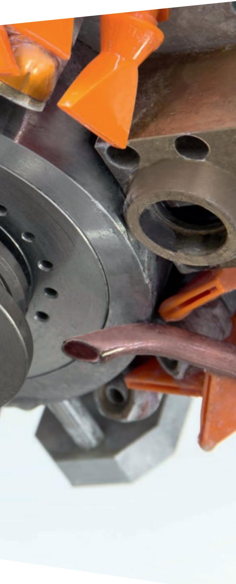
Helix System est né de la volonté de Diamut et Intermac de développer un système révolutionnaire de perçage qui n'existe pas encore sur le marché, capable d'exécuter des trous avec un évasement supérieur et inférieur intégré sur des épaisseurs en verre allant jusqu'à 19 mm d'épaisseur, à l'aide d'un seul outil sur des machines CNC.
