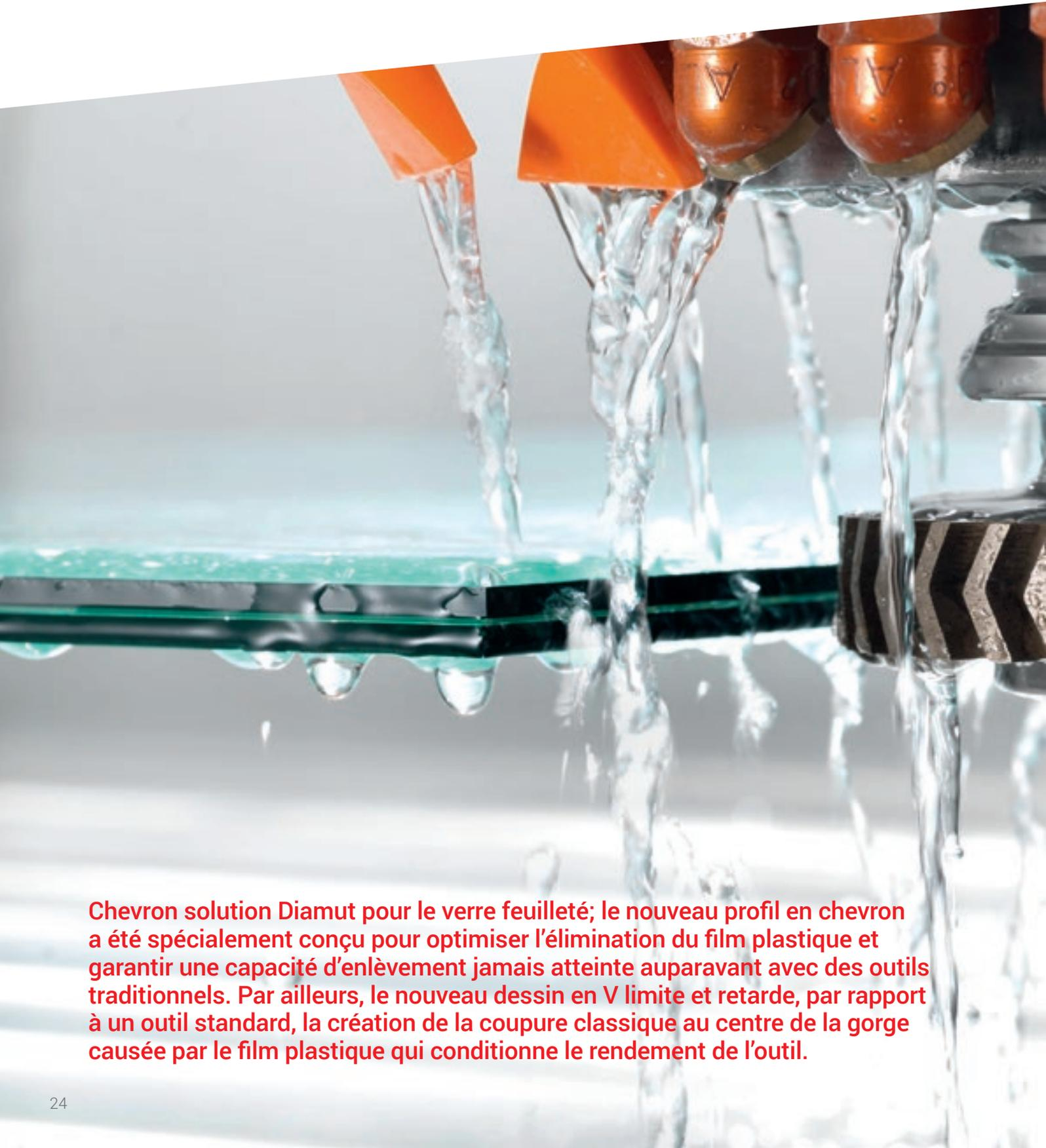
**Chevron solution Diamut pour le verre feuilleté; le nouveau profil en chevron a été spécialement conçu pour optimiser l'élimination du film plastique et garantir une capacité d'enlèvement jamais atteinte auparavant avec des outils traditionnels. Par ailleurs, le nouveau dessin en V limite et retarde, par rapport à un outil standard, la création de la coupure classique au centre de la gorge causée par le film plastique qui conditionne le rendement de l'outil.**
