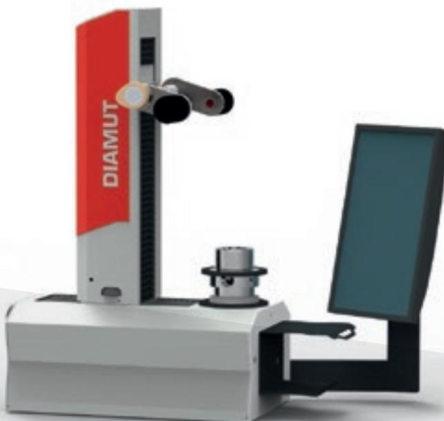
Le nouveau Diamut Presetter est une pièce d'équipement qui lit le profil de l'outil à travers un logiciel entièrement réalisé par Diamut et transférant avec une extrême simplicité au matériel externe toutes les informations paramétriques nécessaires pour utiliser l'outil dans la machine et le préparer à la mise en forme des différents matériaux.
